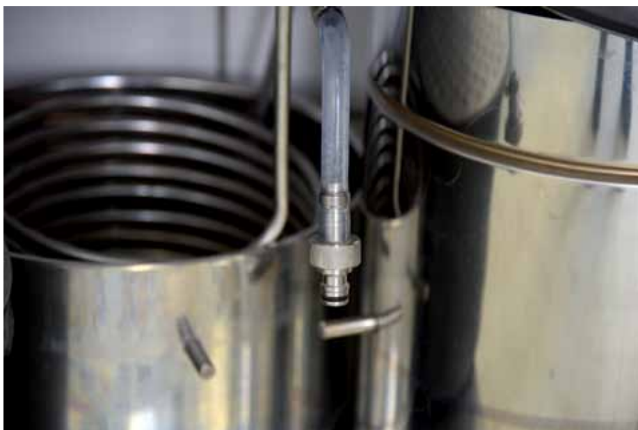
Bei Lillebräu wird buchstäblich per Hand gebraut – sowie mit Kühlspirale und Maischrohr.
