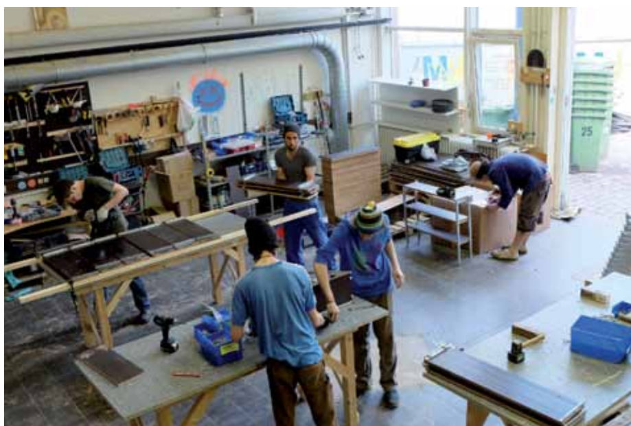
Mitarbeiter von Goldeimer bei der Konstruktion von Komposttoiletten in ihrer Werkstatt (Fotos oben und unten).
